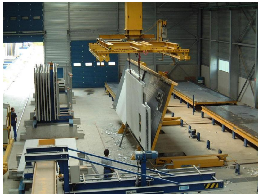
半自动双皮墙生产线的墙板翻转生产（三一筑工也能生产）
