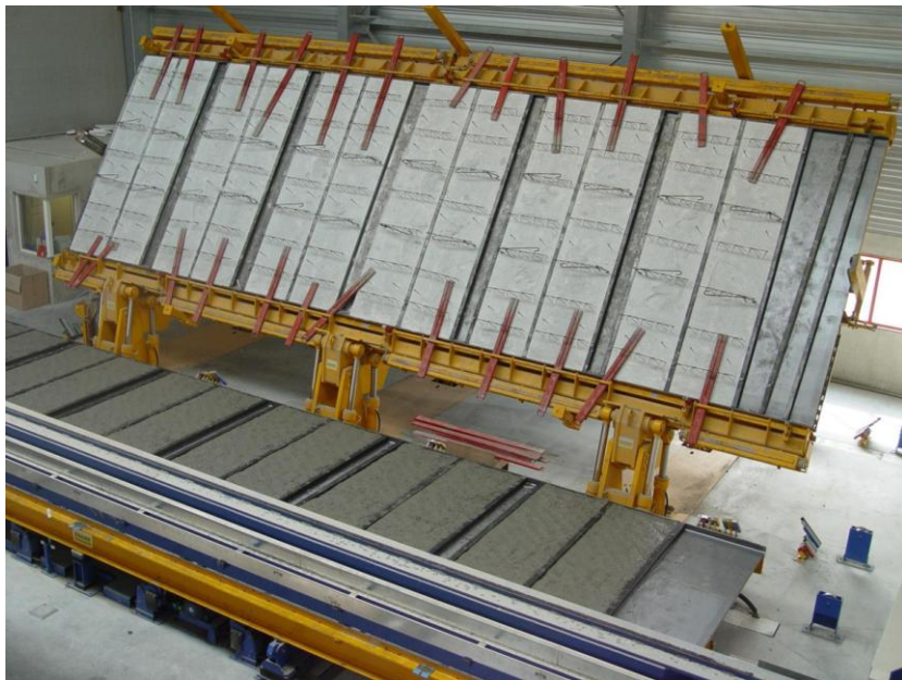
半自动双皮墙生产线的墙板翻转生产（三一筑工也能生产）
